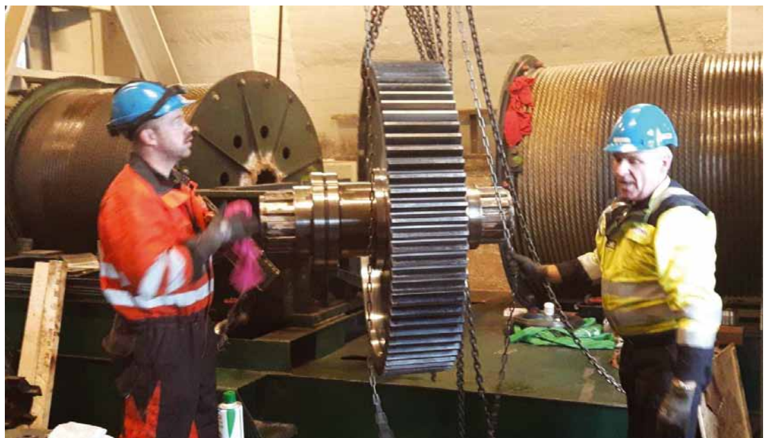
Serviceleder Ronny Joa fra avd. Husnes og Atle Matre fra avd. Bergen heiser hovedtannhullet ut fra girkassen.
