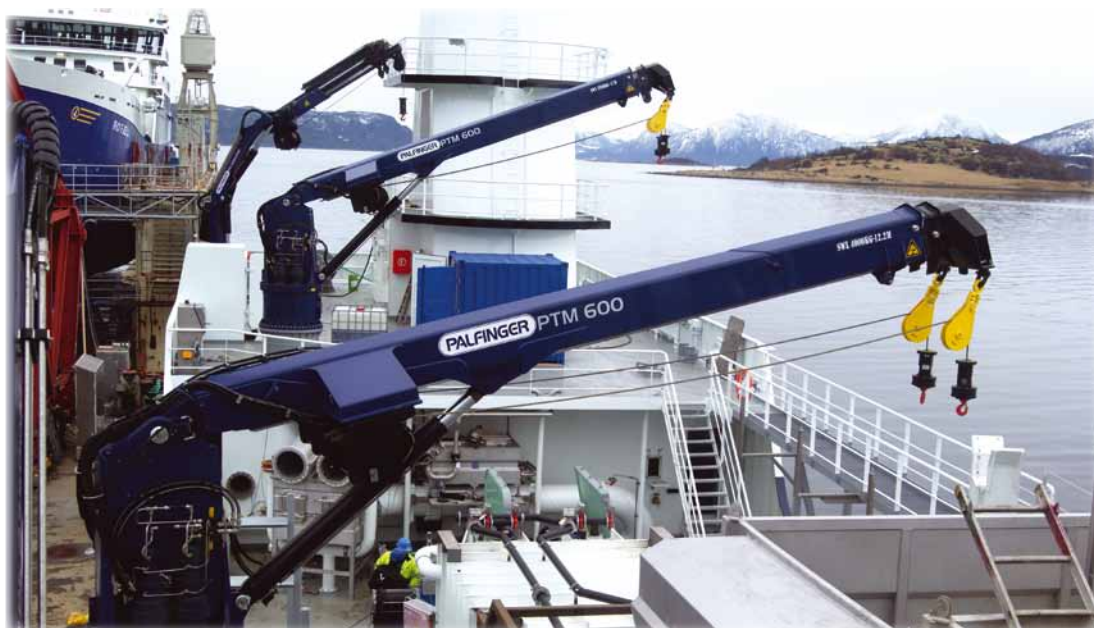
Palfinger PTM 600 kranene som har en blanding av knekkarmkranens robuste design og foldekranens videreutviklede teleskopsystem, gir optimal fleksibilitet når brønnbåten «Ronja Challenger» skal transportere levende laks.
