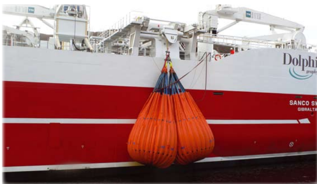
Bildet viser en av mange lasttester KIS MARITIME AS utførte på seismikkskipet "Sanco Sword", de store vannbaggene som ble brukt i denne testen veide tilsammen 105 tonn.
